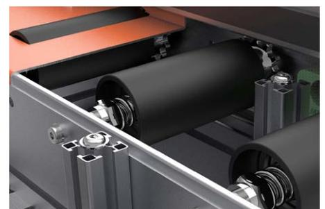
Das Werkstückträger-Transfersystem RMS MAX ist für besonders schwere Lasten konzipiert.
