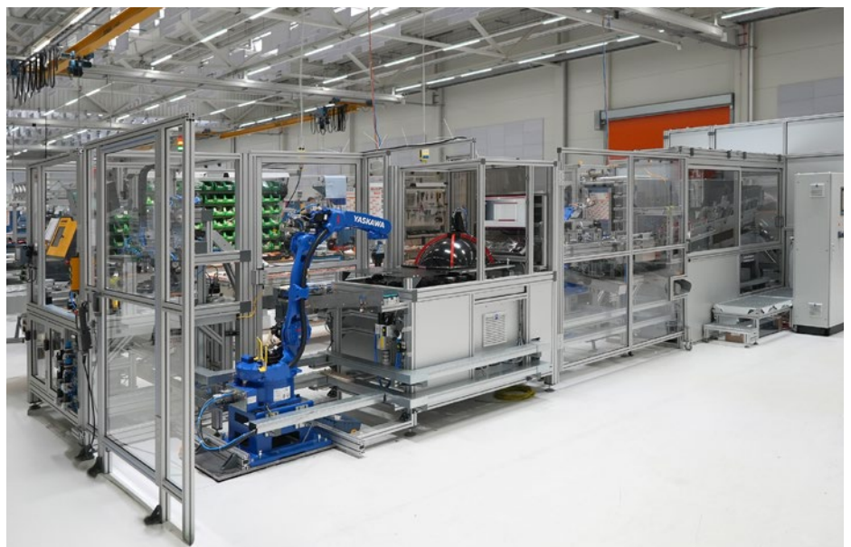
Roboter können Werkstücke zu stationären Qualitätsprüfsensoren bewegen.
