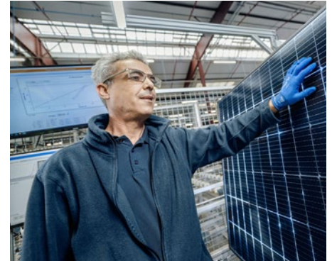
Visual Inspection: Der Mitarbeiter vergleicht die Information am Kontrollbildschirm mit dem Panel.
