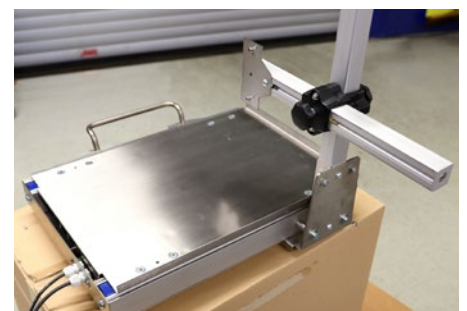
Auch kleinere Standardgeräte, wie ein Markiersystem, entstehen auf Basis des MiniTec-Baukastens.
