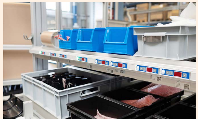
Die Materialversorgung erfolgt von der Rückseite per Kanban.
