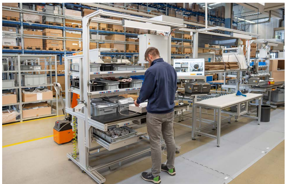
Die Arbeitsplätze können mit dem Baukastensystem vollkommen flexibel gestaltet werden..
