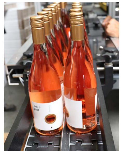
Die Weinflaschen werden auf einer Förderstrecke zur Verpackungsstation transportiert.
