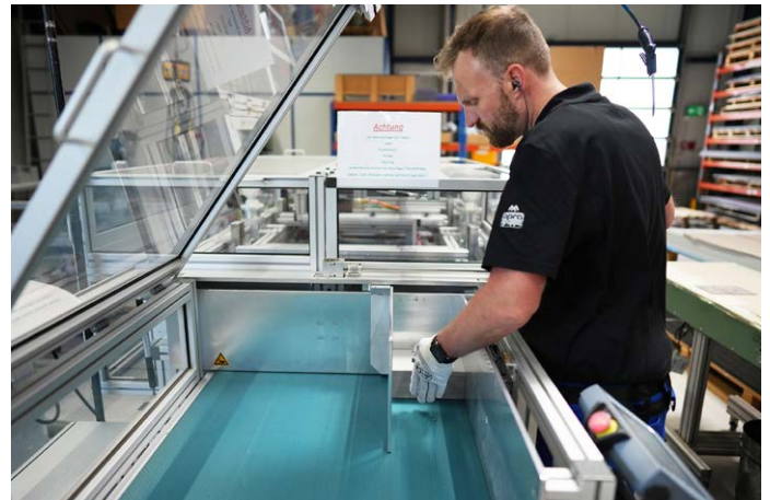
Beim Einlegen der Bauteile stellt ein Anschlag deren präzise Ausrichtung sicher.
