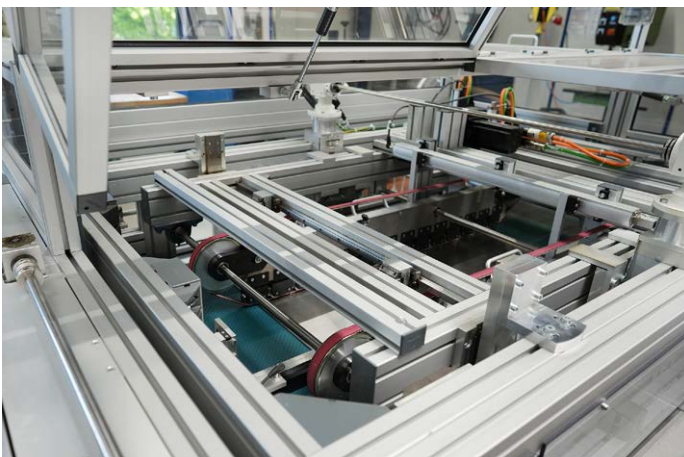
In der Anlage können zwei verschiedene Nutfräser zeitgleich montiert werden.
